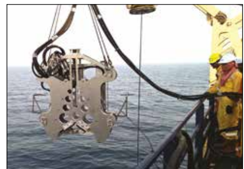
▲ Станок для резки алмазной проволокой MDWS опускается в море.
