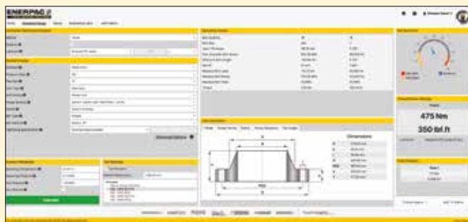
▲ Меню стандартного расчета фланцевого соединения (INFORMATE)
