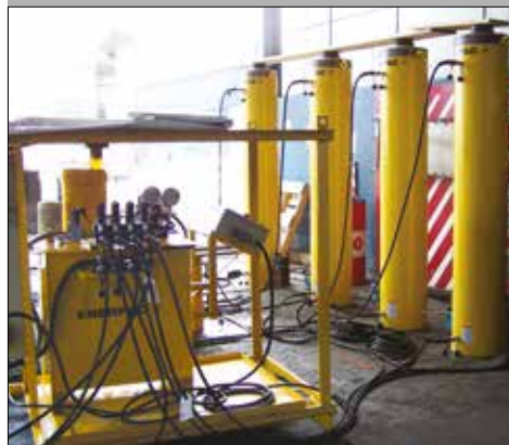
▲ Заказные цилиндры двустороннего действия грузоподъемностью 500 тонн с рабочим ходом 1,83 м для подъема электрических канатных экскаваторов.
