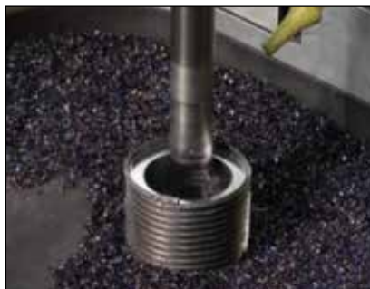
▲ Удаление центра болта (внутренний диаметр резьбы).
