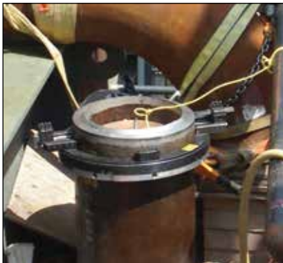
◀ Модель NB — разъемный труборез с узким корпусом.
