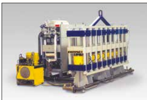
◀ Полностью автоматизированный 1800-тонный высокоточный пресс с управлением на ПЛК. При производстве витков магнитных ускорителей цикл прессования и нагрева требовал приложения больших усилий и высокой точности для обеспечения абсолютного качества.
