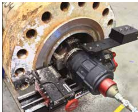
▼ Станок MM860I для обеспечения целостности фланцевого соединения.
